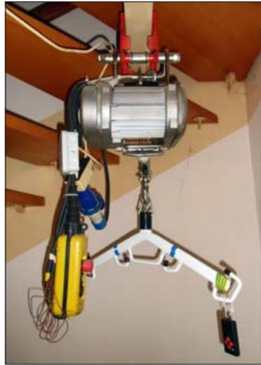
Im wahrsten Sinne des Wortes der Motor des selbst entwickelten Personenaufzugs.
